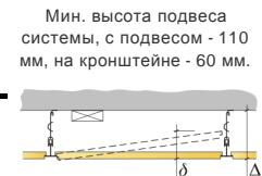
Мин. высота подвеса системы, с подвесом - 110 мм, на кронштейне - 60 мм. Мин. глубина лампатажа
